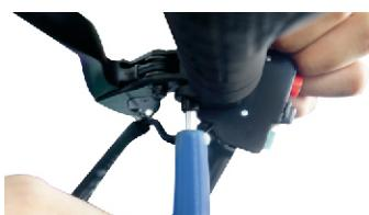
Podesite položaj ručice kočnice i pričvrstite šrafove za fiksiranje sa 5mm šestougaonim imbus klučem.
